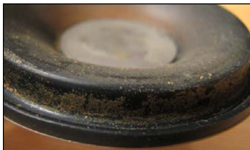
Грязевые отложения на мембране второй ступени.
