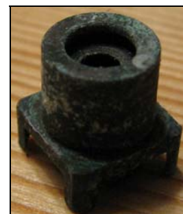
Здесь соль полностью разъела защитное покрытие.
