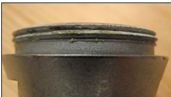
Отложение соли на резьбовом соединении.
